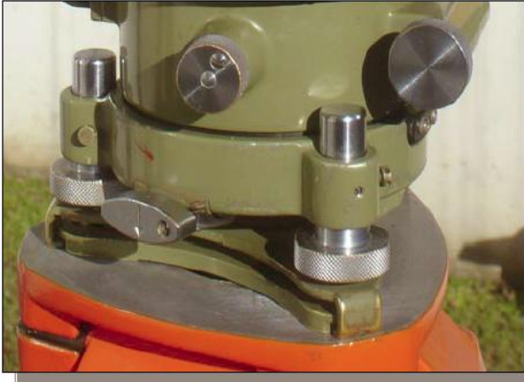
Tornillos de nivelación teodolito Wild
