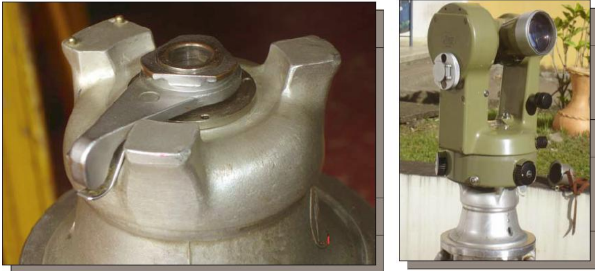
Alineación del ojo de pollo a la pata del trípode
