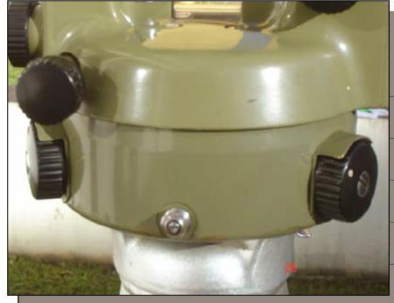
Tornillos de nivelación teodolito Kern
