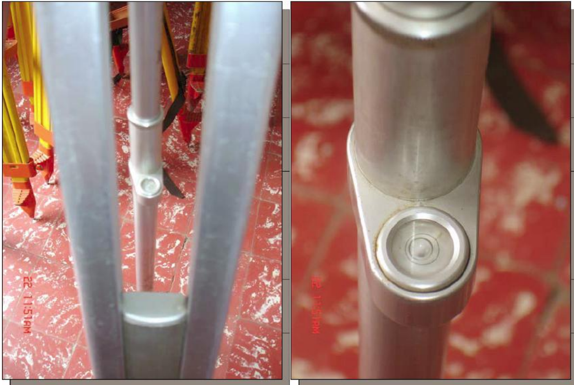
Alineación del ojo de pollo a la pata del trípode
